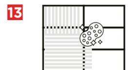
13 Realice el curado de las boquillas 24 horas después de concluida la instalación, el cual consiste en limpiar nuevamente las mismas con una esponja humedecida con agua.
