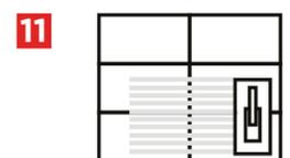
11 Aplique perimetralmente la boquilla en forma diagonal con una llana de goma, asegurando que el espacio entre las juntas se llene completamente.
